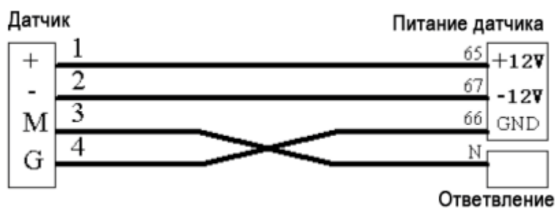
Рисунок 1.3 – Схема подключения датчика отходящей линии.
